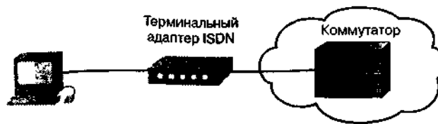
Рис 8 9. В распределенной сети терминальный адаптер соединяет ISDN с другими интерфейсами, такими, например, как коммутаторы
