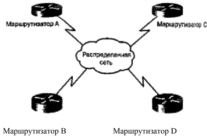
Рис. 8.16. Frame Relay представляет собой пример сетевой технологии с коммутацией пакетов. Она была создана с целью обеспечения большей скорости и простоты в использовании, чем прежние технологии (такие, как X.25), предназначавшиеся для соединения между собой многочисленных сетевых устройств
