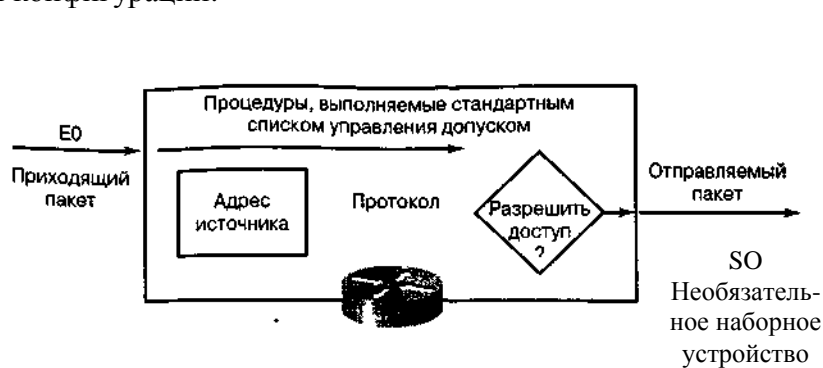
Рис. 6.10. Пакеты, поступающие с интерфейса E0, проверяются на соответствие адресу источника и протоколу
