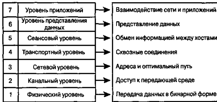
Рис. 1.1. Эталонная модель OSI определяет функции различных уровней, которые могут быть использованы производителями сетевых устройств для облегчения процесса проектирования и модернизации сетей
