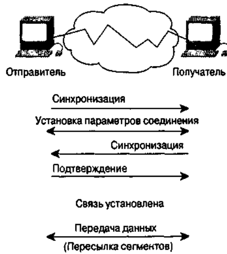
Рис. 1.19. Для того чтобы началась передача данных, как передающая, так и принимающая стороны должны проинформировать свои операционные системы о том, что будет установлена связь
